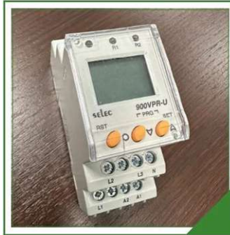
Spannungs- und Frequenzüberwachung: Überwachung der Spannungen aller 3 Phasen inkl. Abschalten bei Phasenausfall, falscher Phasenfolge, Über- oder Unterspannung, Spannungsasymmetrie sowie Über- oder Unterfrequenz. Alle Werte sind voreingestellt
