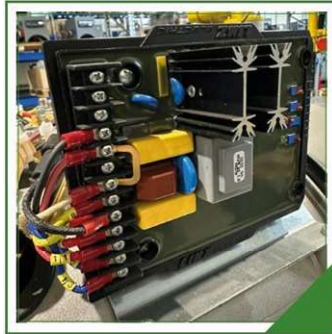
Automatische Spannungsregelung mit 3-phasiger Messung (AVR), Genauigkeit \pm 1\% .
