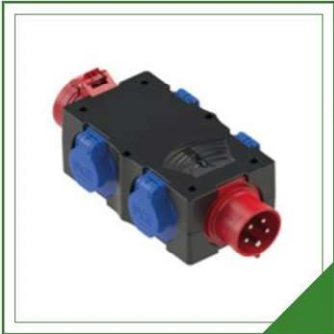
Verteiler-Panel 16amp: Eingangsstecker: 1 x CEE 16A 5P 400V - Steckdose: 1 x CEE 16A 5P 400V + 4 x Schuko 16A 250V IP54
