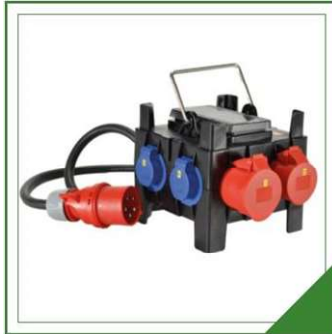
Verteiler-Panel 32amp: Eingangsstecker: 1 x CEE 32A 5P 400V mit 2m Kabel h07rn-f5g4 mm2 Steckdose: 1 x CEE 32A 5P 400V + 1 x CEE 16A 5P 400V + 3 x Schuko 16A 250V IP54 Schutz: 1 Fi 63A/4/0.03A
