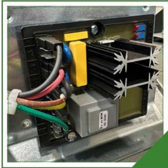
Automatische Spannungsregelung (AVR), Genauigkeit \pm 1\% .
