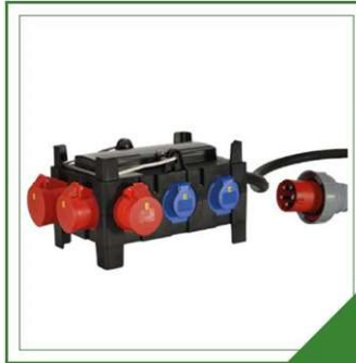
Verteiler-Panel 63amp: Eingangsstecker: 1 x CEE 63A 5P 400V mit 2m Kabel h07rn-f 5g16 mm2 Steckdose: 1 x CEE 32A 5P 400V + 2 x CEE 16A 5P 400V + 3 x Schuko 16A 250V IP54 Schutz: 1 Fi 63A/4/0.03A
